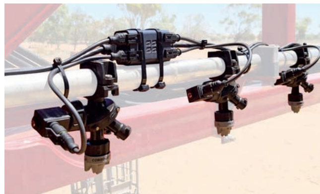
Presný postrekovací systém LeapBox reguluje aplikačnú dávku na základe stabilného tlaku, čím zaisťuje, že sa vždy zachová optimálna veľkosť kvapiek
