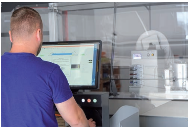
Zariadenie KOMAX Zeta 630 na prípravu káblov
