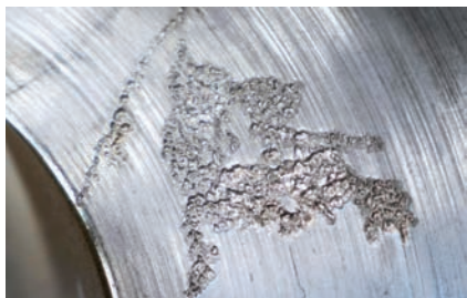
Poškodenie na stene plášťa čerpadla vplyvom kavitácie (Zdroj: Central States Industrial)
